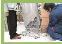
Si noti il taglio e la traslazione di ben 8 cm alla base del pilastro senza il Sistema Midollo®
