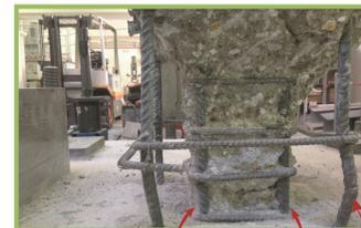
Foto fine prova ciclica su prototipo in c.a. dotato del Sistema Midollo® presso l'Università di Napoli
